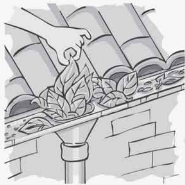
TIRE TUDO QUE POSSA IMPEDIR A ÁGUA DE CORRER PELA CALHA
