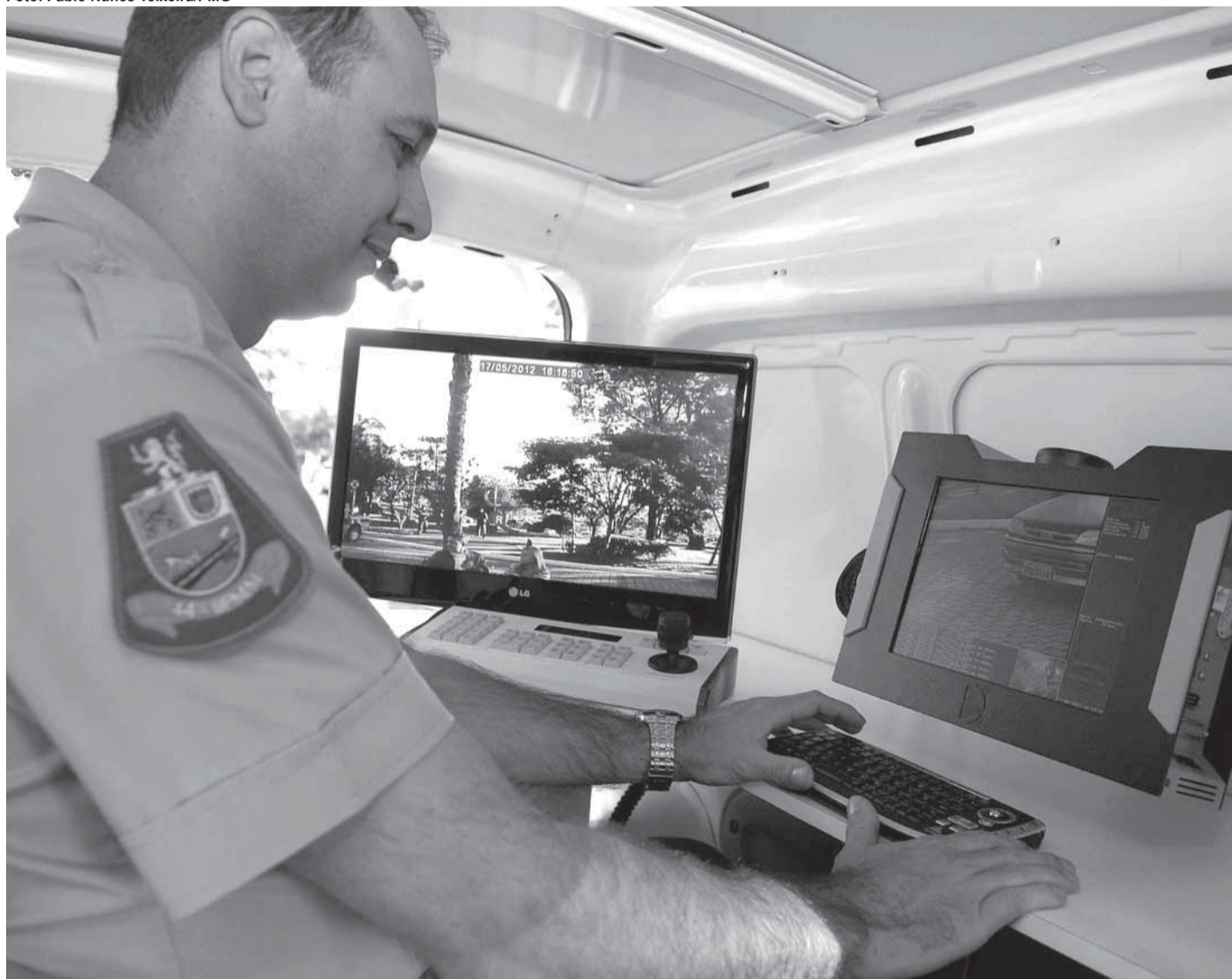
► Van é equipada com monitores que permitem a leitura automática da placa dos veículos em movimento
